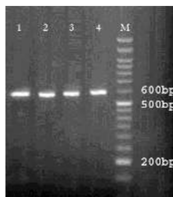
شکل ۱- الکتروفورز محصول PCR بدست آمده از تقویت قطعه 28SrDNA مربوط به ۴ گونه مالاسزیا: ۱- مالاسزیا گلوبوزا، ۲- مالاسزیا فورفور، ۳- مالاسزیا سیمپودیالیس و ۴- مالاسزیا رستریکتا. M- مارکر ۵۰ جفت باز. شکل ۲- الکتروفورز محصول های PCR-RFLP پس از برش با آنزیم CfoI مربوط به ۴ گونه مالاسزیا: ۱- مالاسزیا گلوبوزا، ۲- مالاسزیا فورفور، ۳- مالاسزیا سیمپودیالیس و ۴- مالاسزیا رستریکتا. M- مارکر ۵۰ جفت باز
